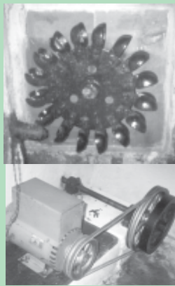
Energia hidroelétrica (doméstica) sistema Pelton, utilizado em S. Roque
